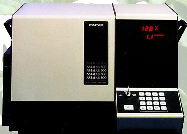
Sistem computerizat pentru determinarea substanței uscate și a amidonului
